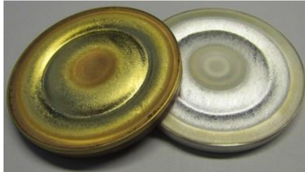
圖 2：平面靶濺鍍後之表面狀態，圖中為金靶與銀靶。
