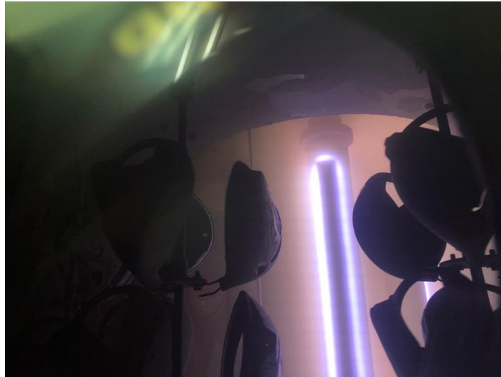
圖 I：電漿濺鍍製程實績，圖中為高爾夫球球員鍍膜製程。
